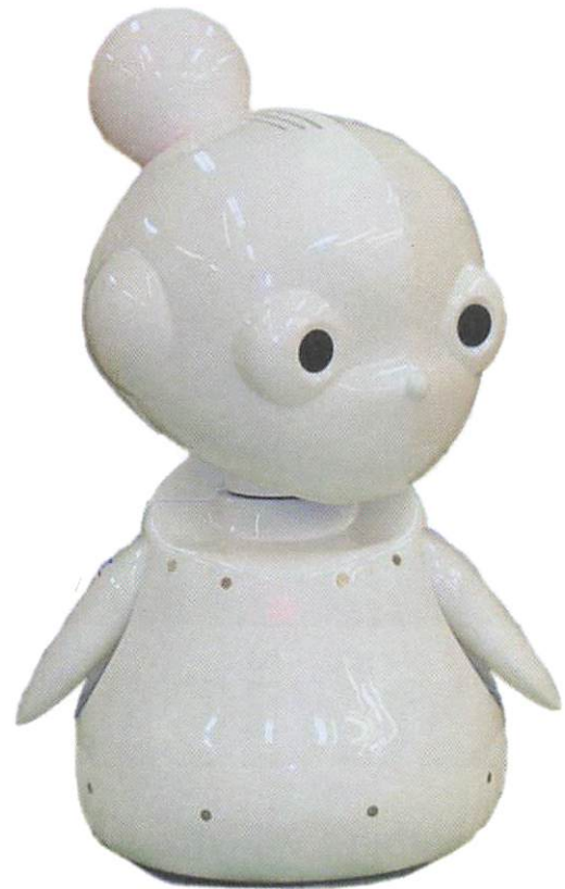
Den lilla mormorsliknande roboten Mamory kan till exempel hjälpa till att hitta saker. Med en inbyggd kamera scannar den av rummet och med programvara jämförs det med hur det såg ut innan.
