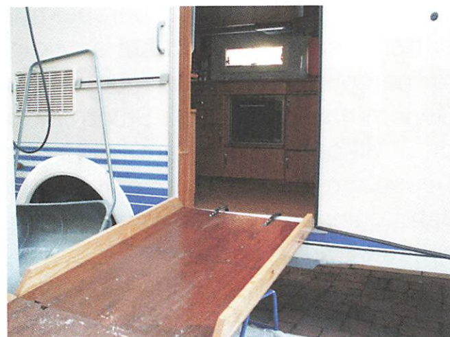
Rampen är ett hemmabygge, tillräckligt lång för att inte lutningen ska bli för stor. Den håller för en permobil.
